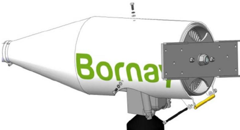
En la parte superior de la carcasa hay tres taladros, para alojar tres tornillos M-8 x 20 con sus correspondientes arandelas M-8 de la serie ancha y una arandela grover, que enroscan directamente sobre el puente del alternador. El orden de instalación es: tornillo, arandela grover, arandela de serie ancha.
