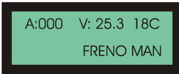
Cuando se activa el conmutador manual de freno, aparece la indicación al final de la segunda línea y además queda iluminado el LED de indicador de frenado.
