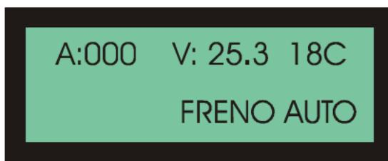
Si el viento es muy fuerte, puede ocurrir que el aerogenerador no se detenga completamente, aunque la energía generada sí se deriva a las resistencias de frenado.
