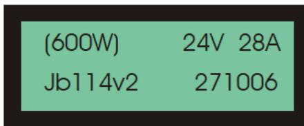
Donde se ve en la línea superior de la pantalla, el modelo del regulador. De izquierda a derecha indica: La potencia del aerogenerador, el voltaje del mismo, y la corriente máxima que acepta. En la línea inferior, aparece la versión del sistema.
