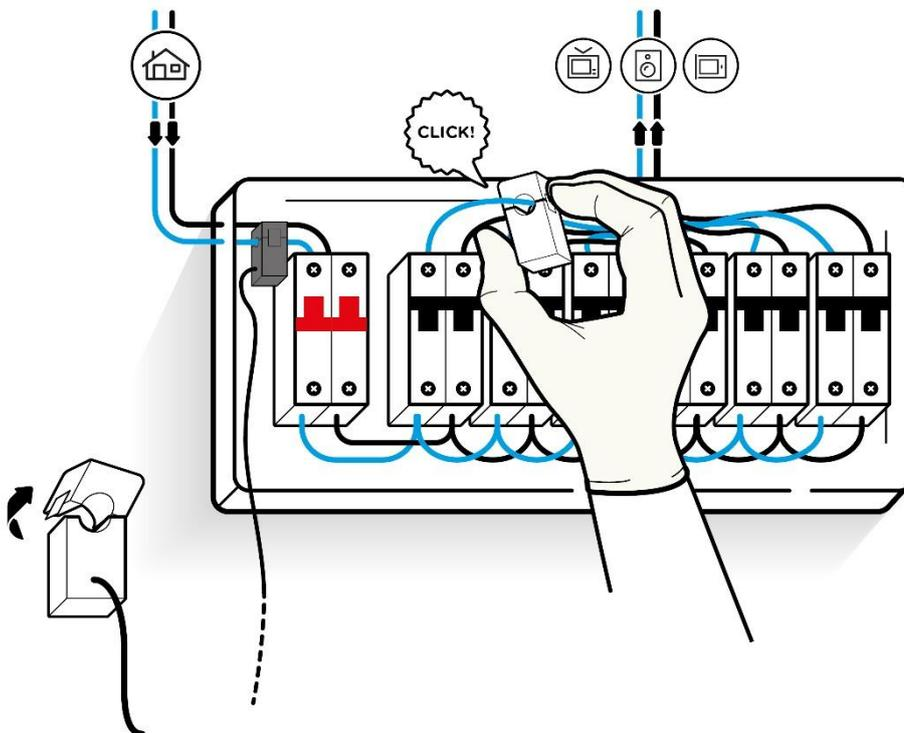
5. Conecta los cables de alimentación al mismo "subcircuito de interés". Para ello tendrás que aflojar un poco los tornillos (bornes) de la protección
