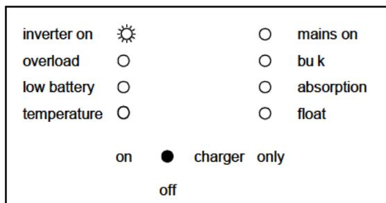
Opm: Wanneer de LED's "overload" en "low battery" tegelijk branden is apparaat uitgeschakeld tgv te hoge rimpel op de gel jkspanning.
