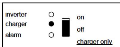
De netspanning is doorgeschakeld en de lader staat in bu k of absorption mode.
