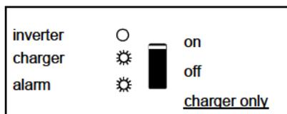
De netspanning is doorgeschakeld en er is een vooralarm: overbelast of de lader is warm.
