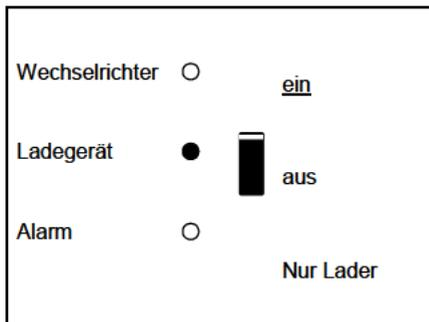
Die Wechselspannung ist durchgeschaltet und das Ladegerät arbeitet im Konstantstrom- oder Konstantspannungs-Modus.
