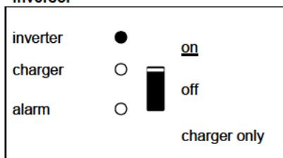
El inversor está encendido y suministra energía a la carga: Battery operation.
