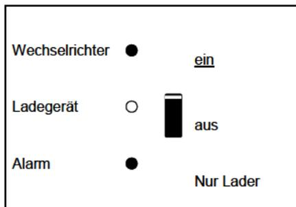
Der Wechselrichter ist ausgeschaltet.
