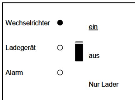
Der Wechselrichter ist eingeschaltet und liefert Leistung an die Verbraucher Batteriebetrieb.
