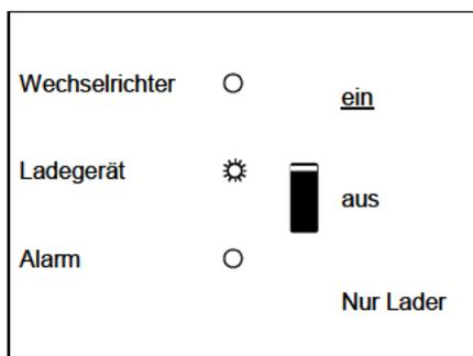
Die Wechselspannung ist durchgeschaltet und das Ladegerät arbeitet im Spannungserhaltungsmodus
