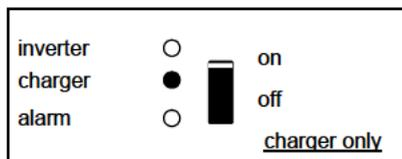
La tension réseau est transférée et le chargeur fonctionne en mode bulk ou absorption.
