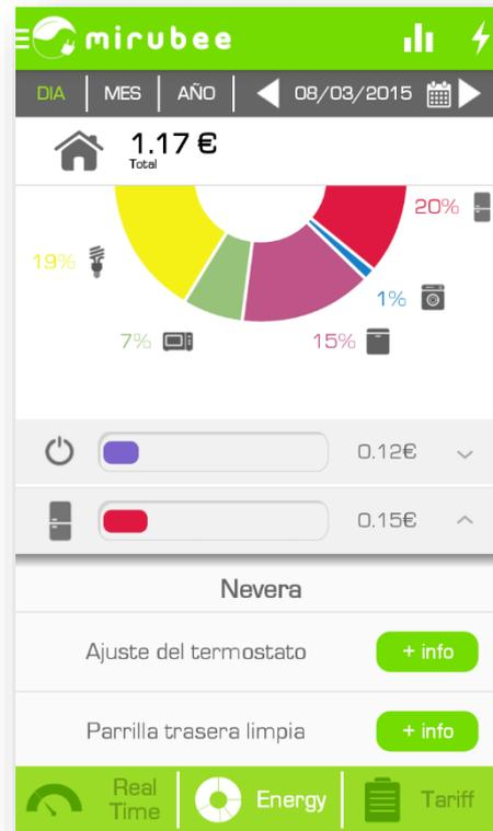
Hay electrodomésticos que no requieren apenas entrenamiento y funcionan casi desde el principio. Es el caso de la lavadora o el microondas. Otros aparatos como la nevera o el termo de agua caliente sanitaria se entrenan automáticamente tras una semana de uso. Por último, hay electrodomésticos más difíciles de entrenar que pueden requerir una pequeña ayuda por tu parte. Es el caso del lavaplatos, horno, calefactor eléctrico, secadora de ropa o vitrocerámica “convencional” (no de inducción).
