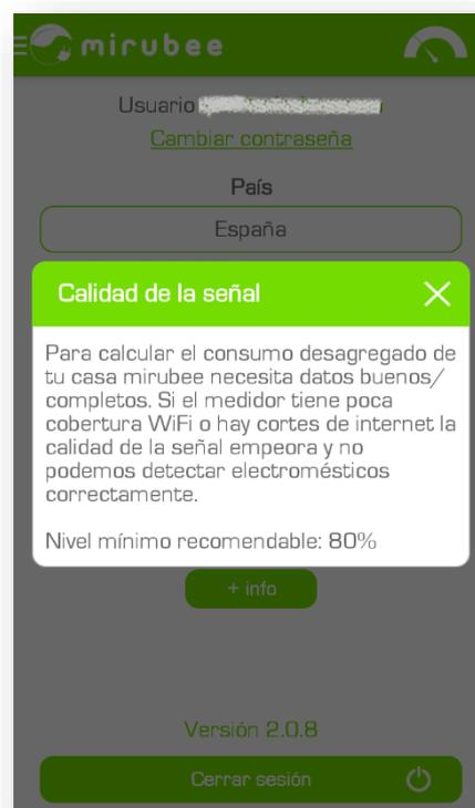
Si la calidad de datos es muy baja y se sospecha que es un problema de cobertura WiFi se puede solucionar instalando un repetidor WiFi en un punto medio entre el router de internet y la mirubox.
