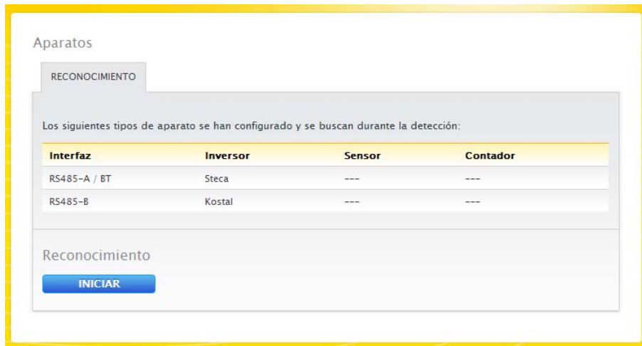
Fig. 49: Detección de aparatos - no iniciada todavía
