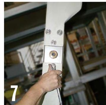
Con pesos y equilibrados similares, se compensan las hélices. Esto evita vibraciones y aumenta la vida útil del Bornay.
