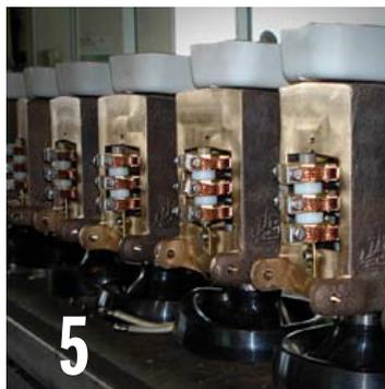
Para la transmisión de la energía entre el aerogenerador y la torre, se utilizan 3 anillos rozantes sobre el eje de orientación y tres juegos de escobillas.
