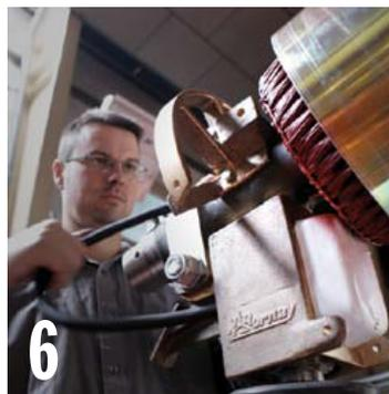
Partiendo de la giratoria, se ensambla el alternador, las hélices y el resto de elementos que conforman el aerogenerador.
