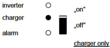
Die Netzspannung ist durchgeschaltet und das Ladeteil liefert Konstantstrom (bulk phase) oder Konstantspannung (absorption phase).
