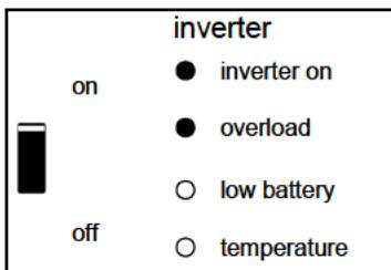
Der Wechselrichter ist wegen Überlast oder Kurzschluss abgeschaltet.
