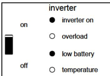
Le convertisseur s'est arrêté à cause d'une tension de batterie faible.
