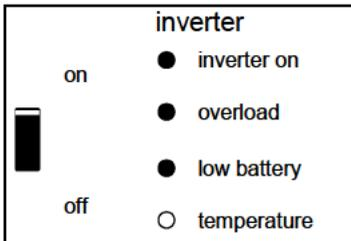
Der Wechselrichter hat sich wegen zu hoher Oberwellenspannung an den Batterieanschlüssen abgeschaltet.
