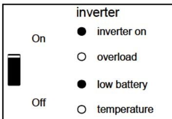
Växelriktaren har stängts av på grund av låg batterispänning.
