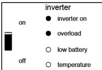
Le convertisseur s'est arrêté à cause d'une surcharge ou d'un court-circuit.
