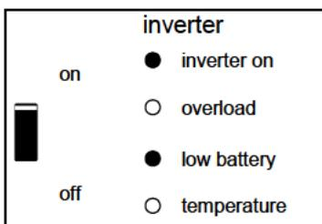
Der Wechselrichter hat sich wegen Unterspannung der Batterie abgeschaltet.
