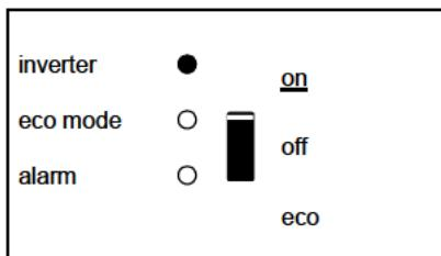
Der Wechselrichter ist eingeschaltet und liefert Strom an die Verbraucher.
