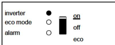
Batterij bedrijf. De omvormer staat aan en levert vermogen aan de belasting.
