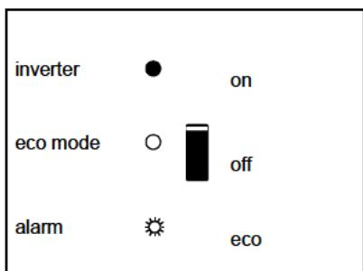
Der Wechselrichter ist eingeschaltet und liefert Strom an die Verbraucher.
