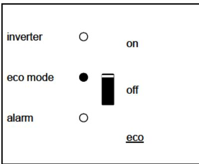
Der Wechselrichter arbeitet im "eco mode"
