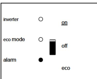
Der Wechselrichter ist ausgeschaltet.
