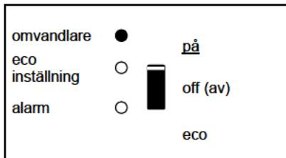
Omvandlaren är igång och levererar kraft till lasten. Batteridrift.
