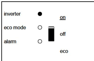
Der Wechselrichter ist eingeschaltet und liefert Strom an die Verbraucher.
