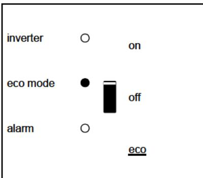
Der Wechselrichter arbeitet im "eco mode"
