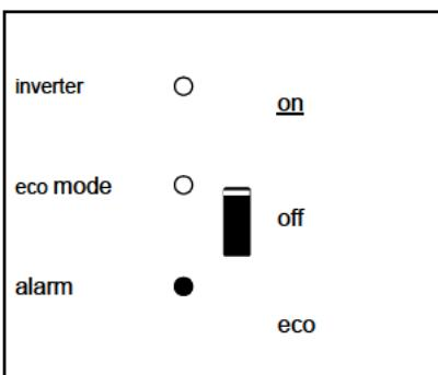
Der Wechselrichter ist ausgeschaltet.
