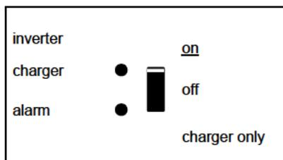
La tensión CA de entrada se conmuta y el cargador se apaga. El cargador de baterías no puede alcanzar la tensión final de la batería (modo de protección Bu k).
