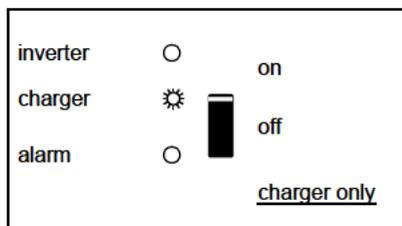
La tension d'entrée CA est commutée et le chargeur fonctionne en mode float.
