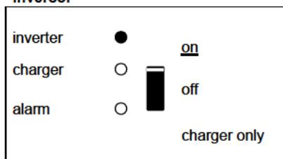
El inversor está encendido y suministra energía a la carga: Battery operation.
