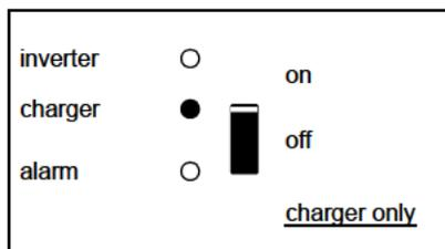
La tension d'entrée CA est commutée et le chargeur fonctionne en mode Bulk ou absorption.
