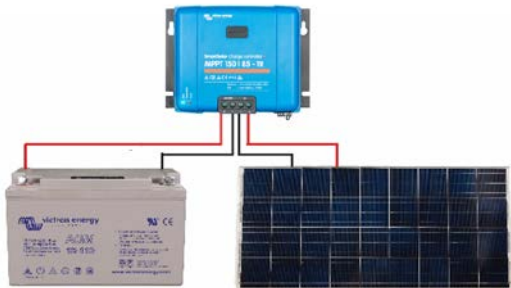
Figure 1: Power connections Illustration 1 : Connexions électriques Abbildung 1: Stromanschlüsse Figura 1: Conexiones de alimentación Bild 1: Strömanslutningar
