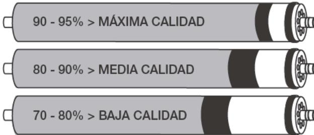
Por debajo del 70% la vida de la membrana ha llegado a su fin. Mediante un conductímetro o un medidor TDS, compare la conductividad del agua de entrada con la de la salida de la membrana, y obtenga el porcentaje de rechazo de sales.
